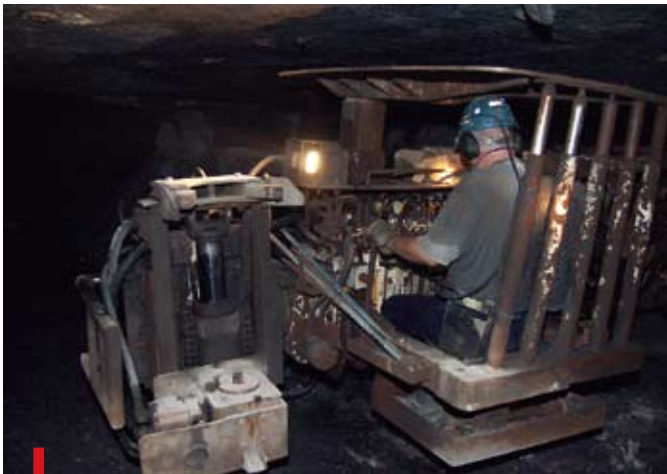
Nie wszystkie maszyny mają klimatyzację. Operator kotwiarki zabezpieczającej strop pracuje w wyjątkowo trudnych warunkach
