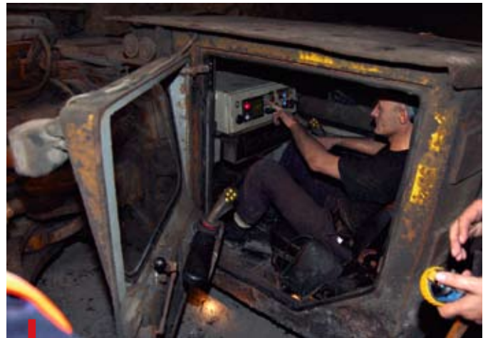
W tej kopalni złoża miedzi są cienkie. To wymaga specjalnych maszyn o wysokości 1,4 m. Na zdjęciu: W ładowarce siedzi się bokiem do kierunku jazdy
