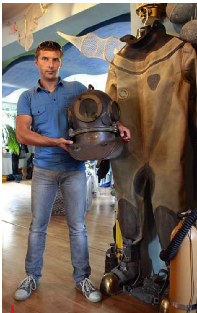
Tak wygląda rosyjski kombinezon do nurkowania z lat 60. But waży 10 kg, hełm około 30 kg – demonstruje Krzysztof Mann
