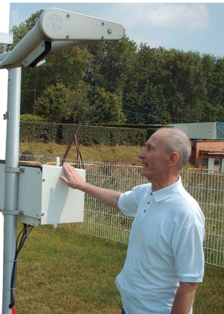
Na linii widocznościomierza nikt nie może zapalić ogniska. Wtedy pomiar byłby przekłamany
