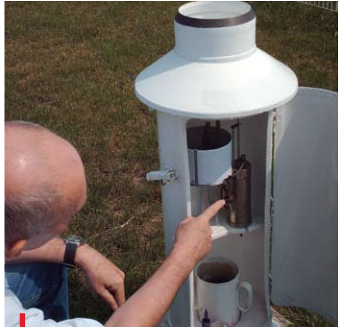
Pluviograf to urządzenie zapisujące ilość opadów
